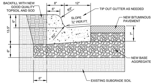
**B612 CONCRETE CURB & GUTTER DETAIL**
